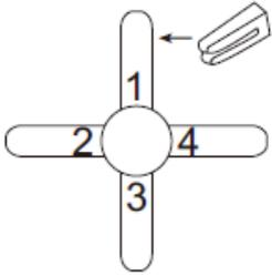
Poner el clip en el centro de una pala, encender el ventilador, si la oscilación persiste, cambiar el clip a otra pala y así hasta encontrar la pala que reduzca el bamboleo, en esta pala será en la que haya que colocar el contrapeso.
